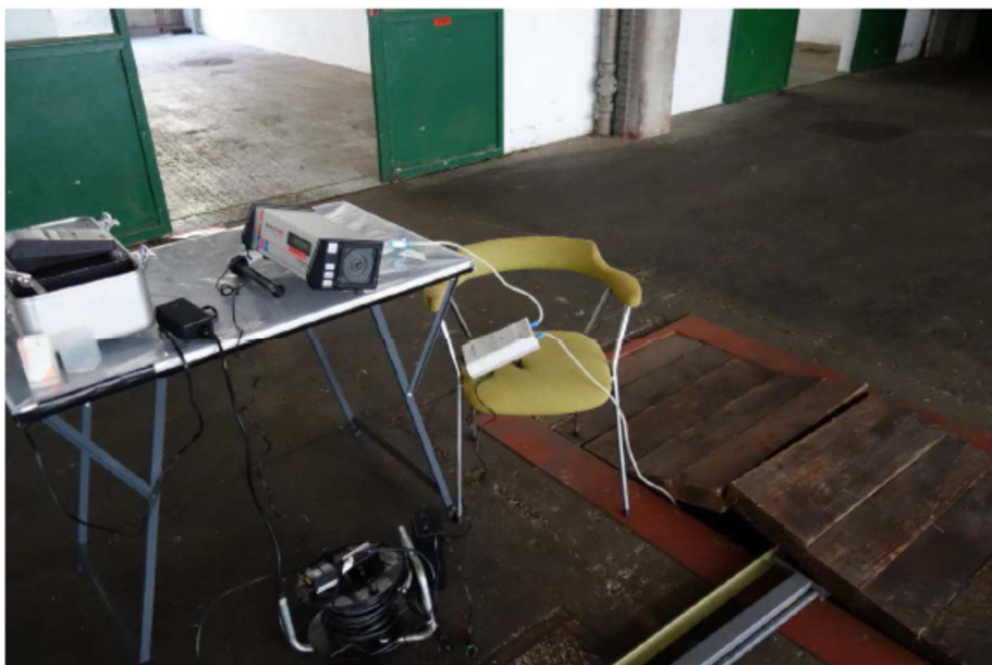
Slika 4: Meritev koncentracije radona v zraku v revizijskem jašku v objektu 104. Pokrov jaška je bil pred in med meritvijo odprt, le toliko, da je bilo mogoče namestiti cev, po kateri je črpalka črpala zrak.
