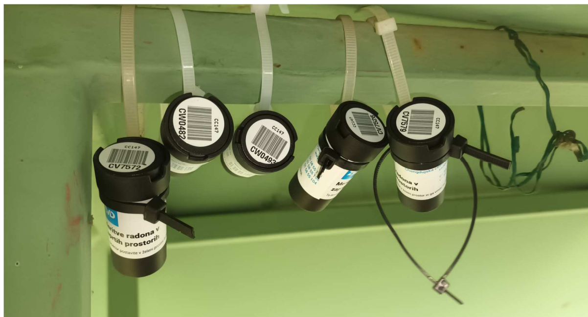
Slika 5: Meritve koncentracije radona z detektorji sledi na merilnem mestu.
