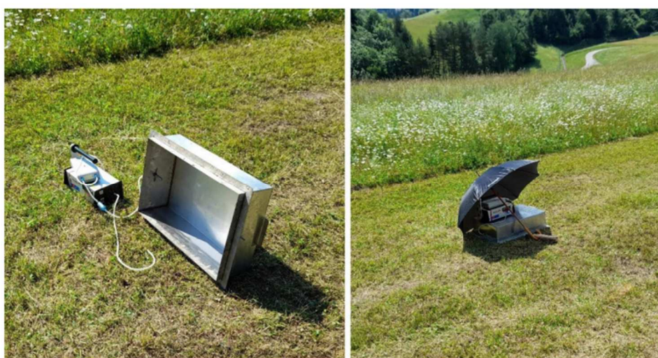
Slika 4: Merilna oprema in izvajanje meritev radonskega toka skozi prekrivko na pobočju odlagališča Jazbec.
