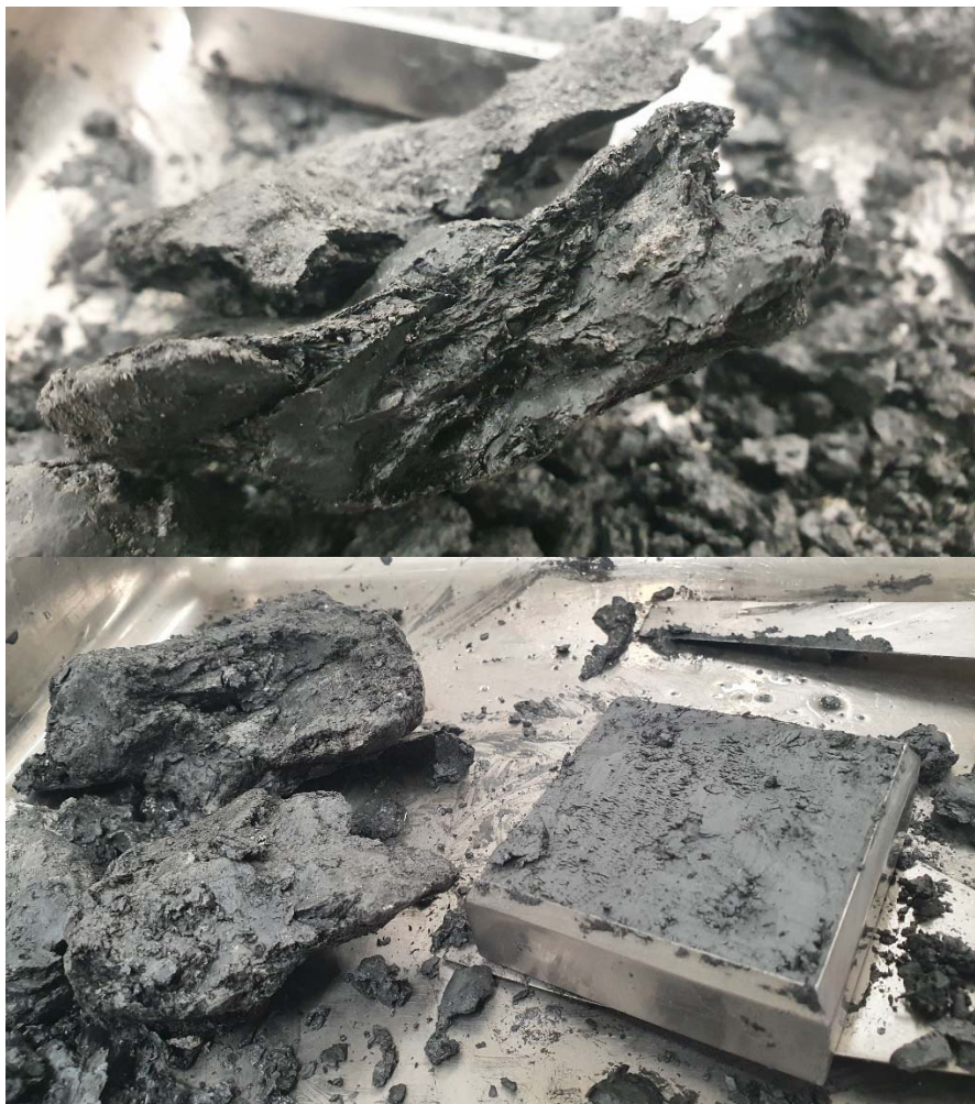
Slika 3: Vgrajevanje pregnetenega glinavca v strižno celico (V5, 9.5-9.7m)
