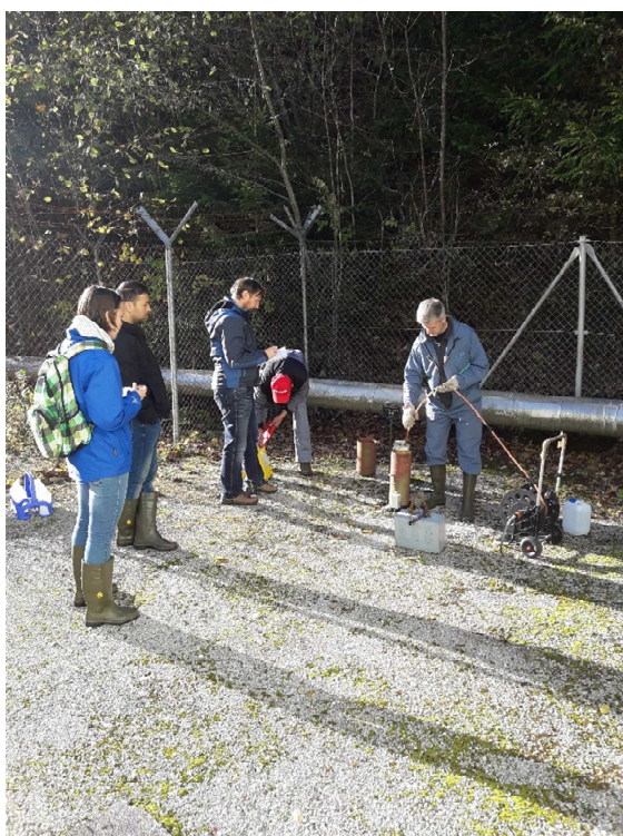
Slika 5: Vzorčenje vode iz piezometra.
