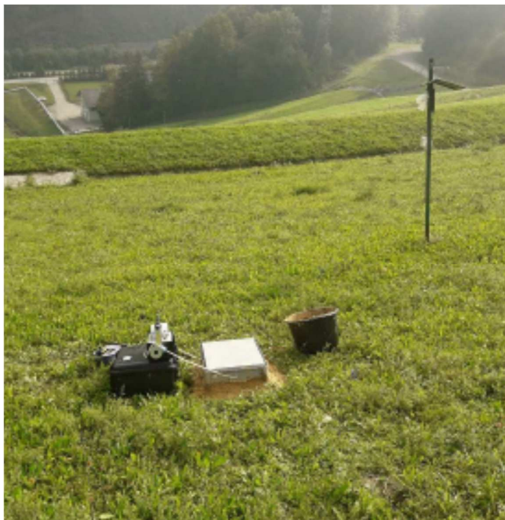
Slika 4: Izvajanje meritev radonskega toka skozi prekrivko na pobočju odlagališča Jazbec.
