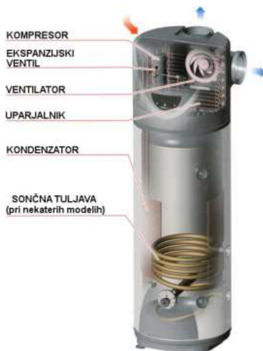
Slika 50: Sodobna toplotna črpalka z zalogovnikom za pripravo tople sanitarne vode (vir: www.http://toplotna.si )
