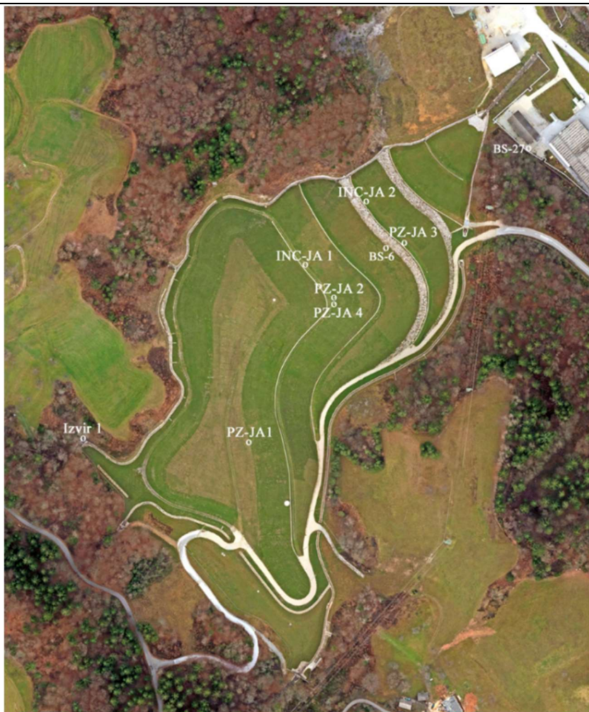
Slika 12: Lokacije piezometrov in inklinometrov na odlagališču Jazbec
