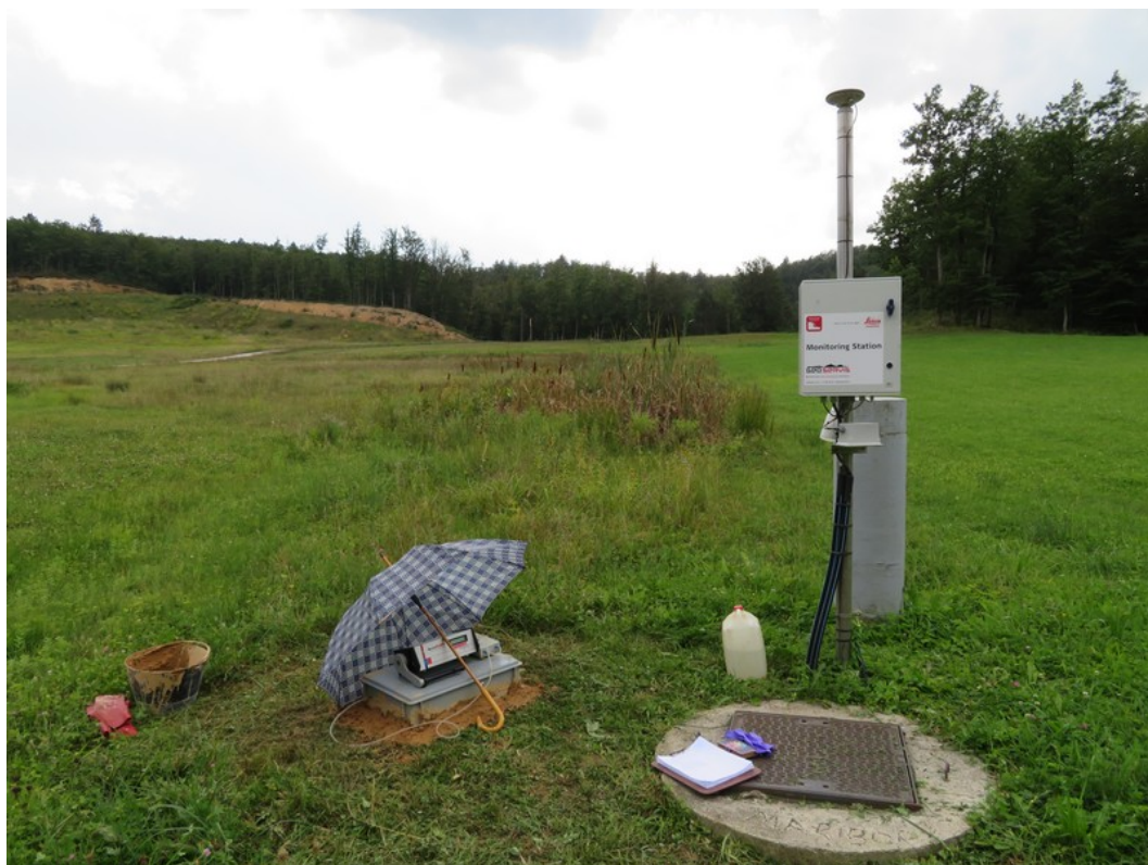
Meritve radonskega toka na pridobivalnem prostoru Jaka
