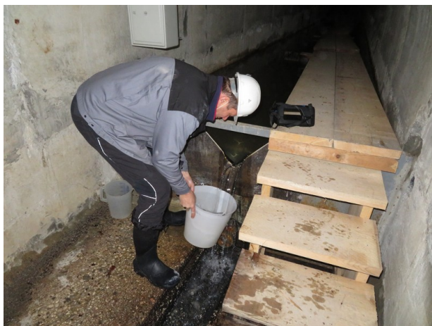
Merjenje pretoka v drenažnem rovu na MM Tunel (levo), pobiranje podatkov avtomatskih meritev nivoja na prelivu MM BPG (desno)
