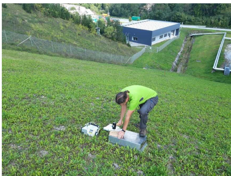
Slika 5: Izvajanje meritev radonskega toka skozi prekrivko na pobočju odlagališča Jazbec.
