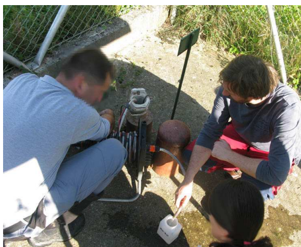
Slika 6: Vzorčenje vode iz piezometra.
