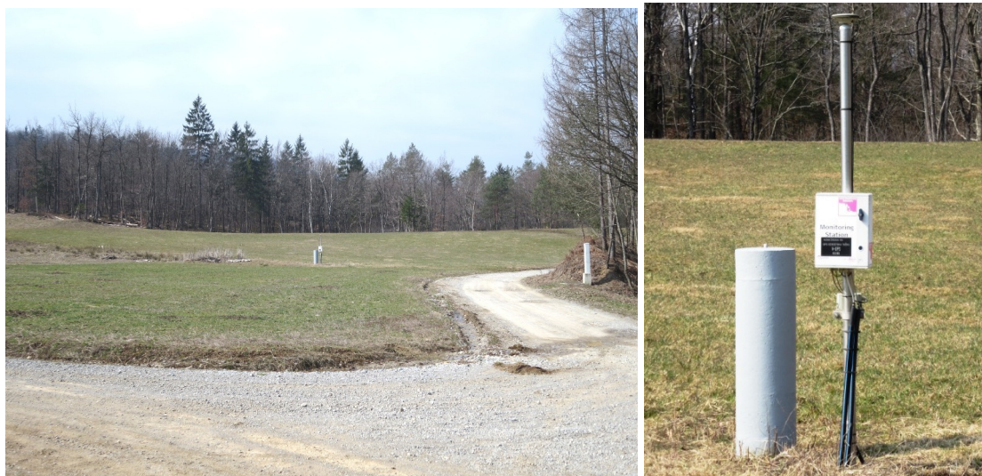
Slika 3: Opazovalna točka GRS1 GPS nadzora stabilnosti območja odlagališča Boršt na saniranem kopu inertnega materiala Jaka za prekrivko odlagališč Jazbec in Boršt
