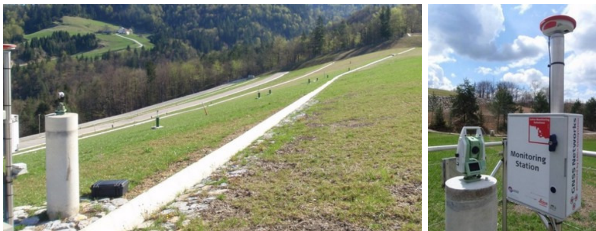
Slika: Opazovalna točka II-GPS z nizom kontrolnih točk in opazovalna točka ob permanentni GNSS postaji GMX2
