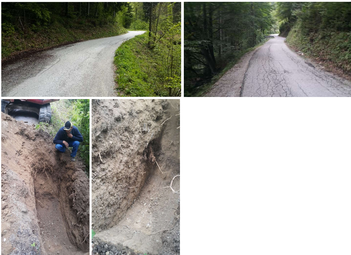
FOTO 5-8: Območje usada 3 in sondažni jašek, ki je dosegel podlago na 1,7 m
