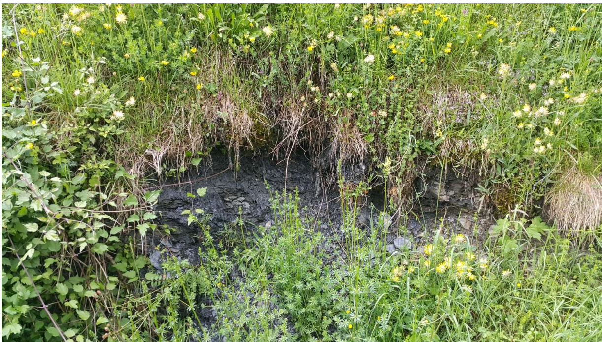
FOTO 5: Golica – Močno pregneteni skrilavi glinovci prevzemajo lastnosti gline.
